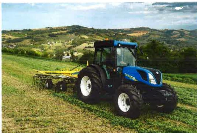
Το T4LP διαθέτει νέο εμπρόσθιο άξονα βαριάς κατασκευής, με νέα χυτοσιδηρή στήριξη που προέρχεται από τη σειρά T4 utility, η οποία του δίνει τη δυνατότητα για τοποθέτηση φαρδύτερων ελαστικών για λειτουργία με ευκολία και εξαιρετική σταθερότητα ακόμη και με μεγαλύτερα παρελκόμενα, όπως οι εμπρόσθιοι φορτωτές ή τα ελαιοραβδιστικά.
